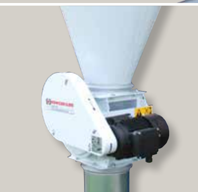
Tolva de recepción CAE 20 montada debajo el ciclón, en una instalación de pura aspiración.
