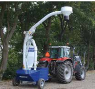
La turbina de succión SupraVac 2000 preparada para cargar el grano en un camión.
