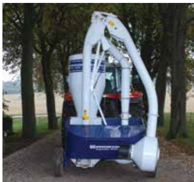
El brazo de descarga plegado hidráulicamente en posición de transporte.
